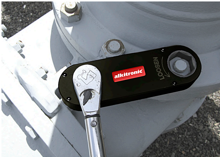
Exemple d'application : Opération d'assemblage avec le multiplicateur manuel M-ML lors de la construction d'une usine.
