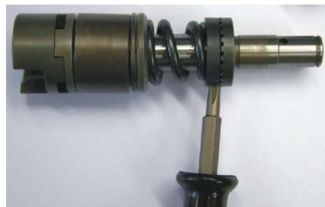
Retirez l'écrou de réglage et le disque de pression
