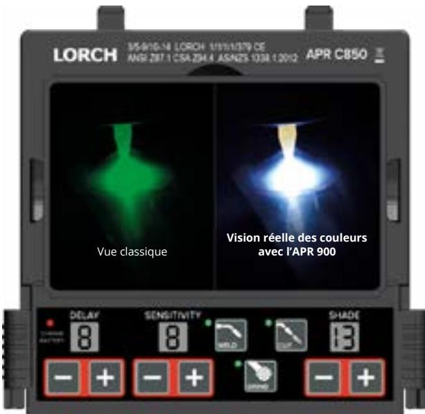
**Utilisation et modes de fonctionnement :** possibilité de réglage pour les modes de fonctionnement, le niveau de protection, la temporisation et la sensibilité à l'aide de boutons clairement identifiés et d'un écran lisible en permanence. Le mode de soudage (niveau de protection 10-14), le mode de meulage (niveau de protection 3) et le mode coupage (niveau de protection 5-9) sont disponibles pendant le fonctionnement.
