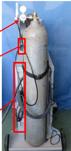
Photo du branchement du câble d'alimentation
