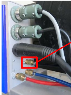
Photo du branchement du câble d'alimentation
