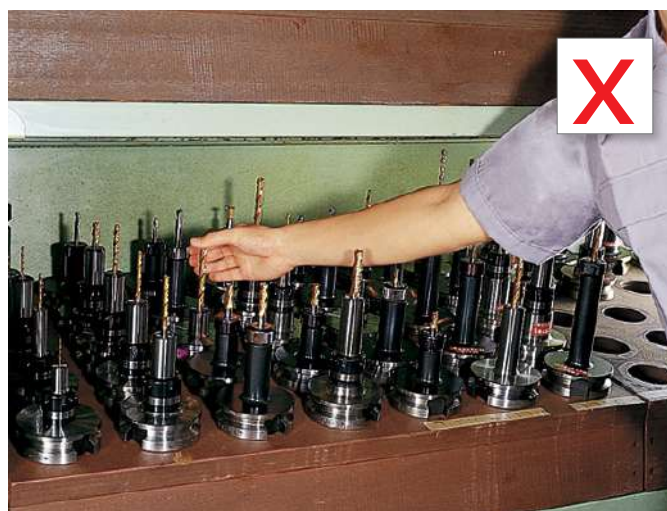
Avant : risque de blessure
